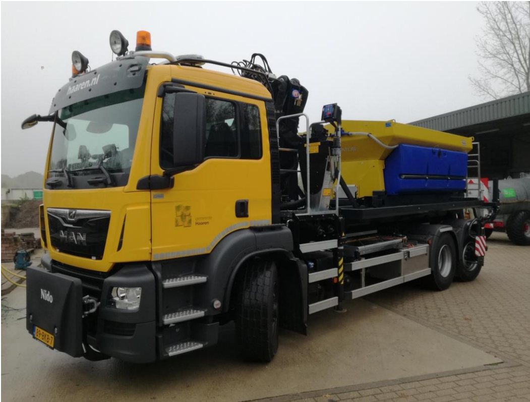
Foto 2: vrachtwagen (merk MAN) met een combistrooier ten behoeve van de gladheidbestrijding.
